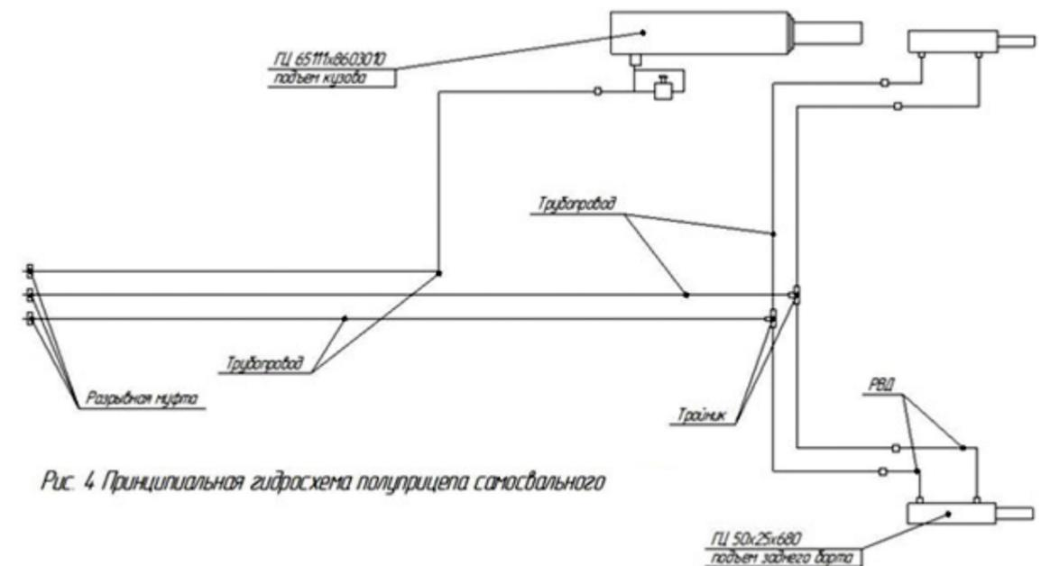
Рис.4 Принципиальная гидросхема полуприцепа самосвального
