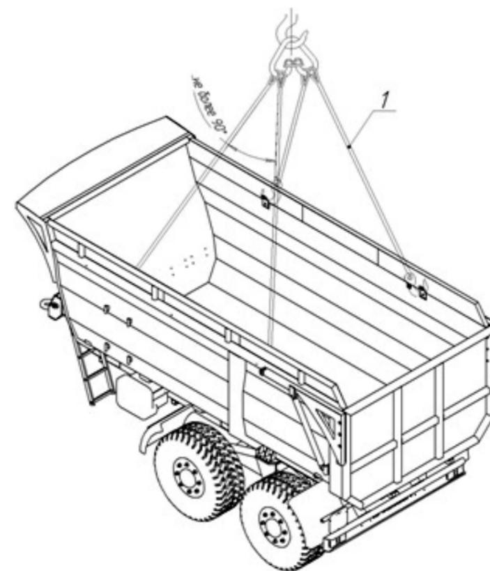
Рис. 8. Принципиальная схема строповки полуприцепа.
