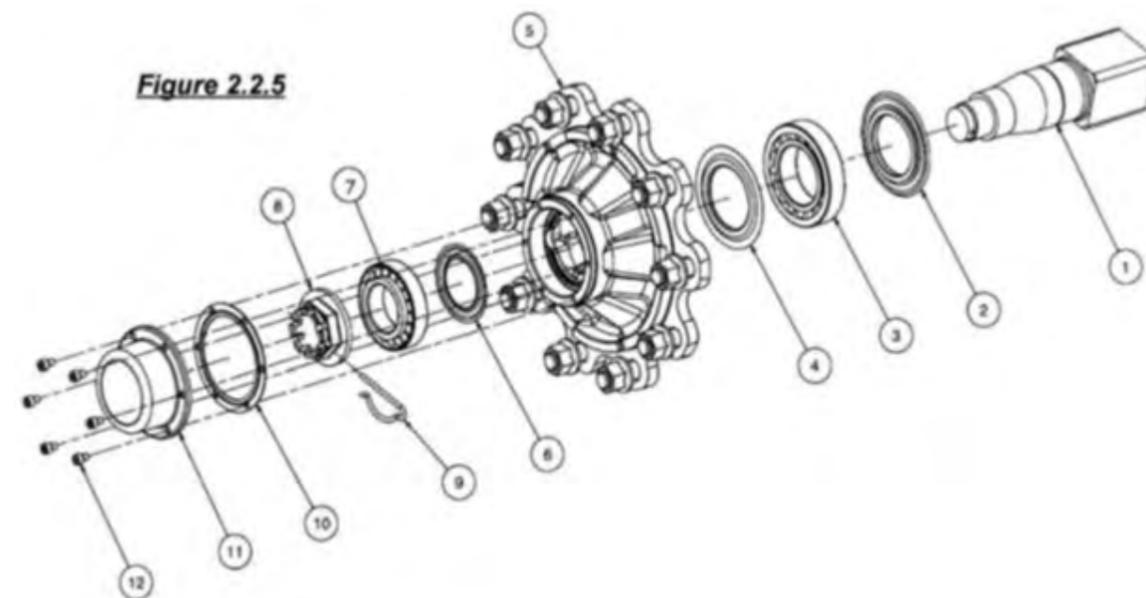
Рис. 5 Схема регулировки подшипников ступиц колес ПС-12БМ
