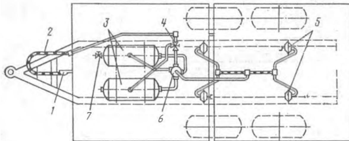
Рис.2 Пневматическая схема полуприцепа ПС-12
