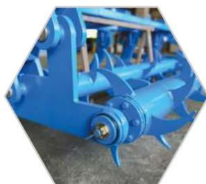
Зубовый каток комплектуется специальными амортизационными подшипниками.
