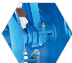
Надежные подшипниковые узлы не требуют обслуживания в течение всего срока эксплуатации. Защищены от загрязнений и механических повреждений.
