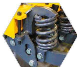
Пружинный амортизатор защищает диск и стойку от перегрузок, поддерживает заданную глубину, создает дополнительную вибрацию.
