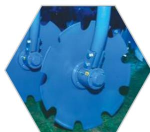
Надежные подшипниковые узлы имеют повышенный ресурс и не требуют обслуживания в течение всего периода эксплуатации.
