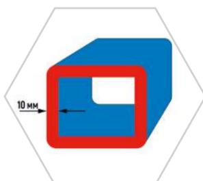
Рама изготовлена из прочной конструкционной легированной стали (толщина трубы - 10 мм).
