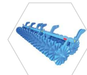
Планочно-трубчатый каток с амортизационными элементами пружинного типа (опция)
