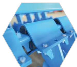
Резиновые амортизаторы защищают диск и стойку от перегрузок, поддерживают постоянную глубину обработки.
