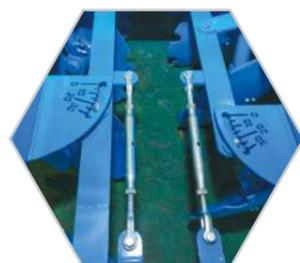
Простая регулировка угла атаки дисков от 0 до 30 градусов при помощи талрепа и тяги рабочих органов.
