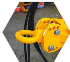
Регулируемая сцепная петля для удобства агрегатирования с тракторами различных производителей с разными по высоте прицепными устройствами.
